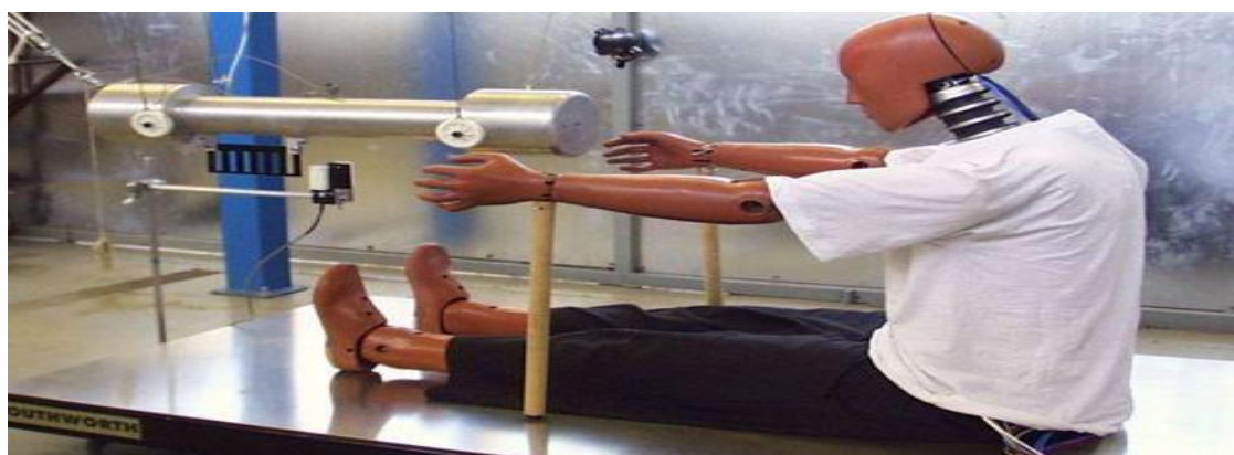
2-rasm – Qo'g'irchoqning boshi, bo'yni, ko'krak va oyoqlari eng aniq datchiklar bilan jihozlangan – jami 34 dona.
